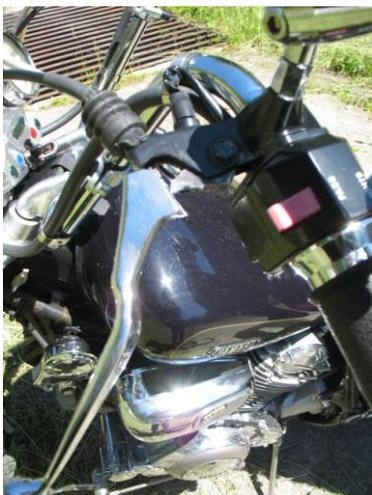
Wir müssen mit Bordmitteln reparieren. Nach einigem Überlegen entfernen wir die Umlenkung und befestigen einen T-Inbusschlüssel mit Kabelbindern am Hebel, der mit diesem nun eine ziemlich labile Hebelmimik bildet. Leider ist die
